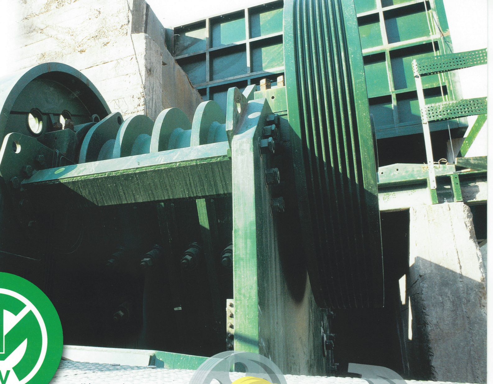
Volano con gole Grooved flywheel
